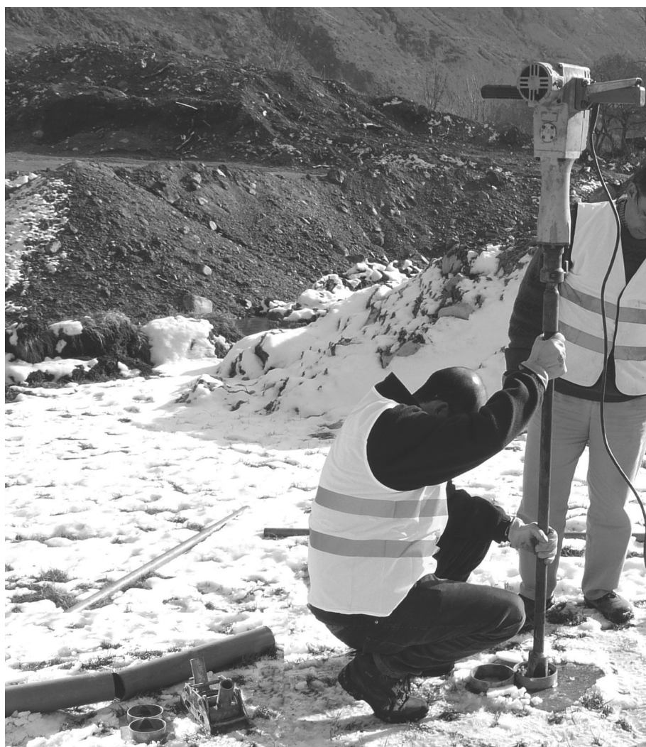
FIGURA 4. Sondeig de percussió a la torbera de València d'Àneu. FOTOGRAFIA: Ramon Pérez-Obiol.
